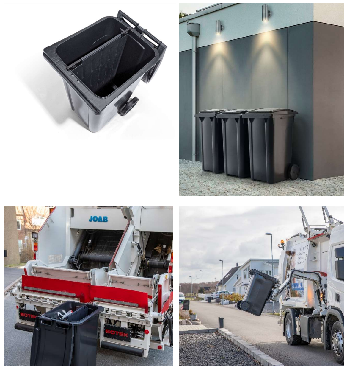
Figur 3. Tvåfackskär och tvåfacks baklastandebil samt sidlastandebil enligt San Sac. Foto: SanSac
